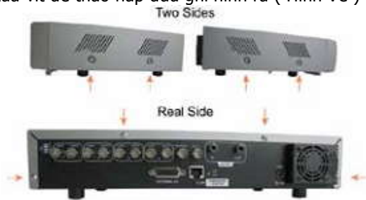
STEP1-1: Remove Screws
